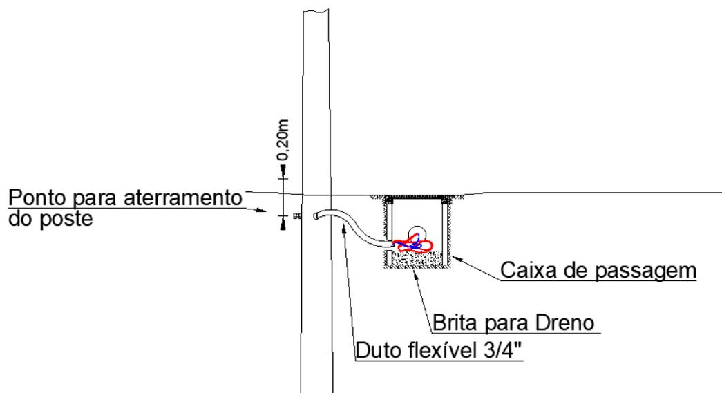
Figura 46 - Esquemático do aterramento
