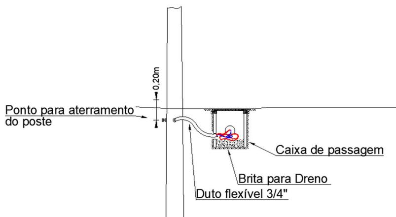
Figura 4 – Ligação do condutor de proteção ao ponto de aterramento do poste metálico
